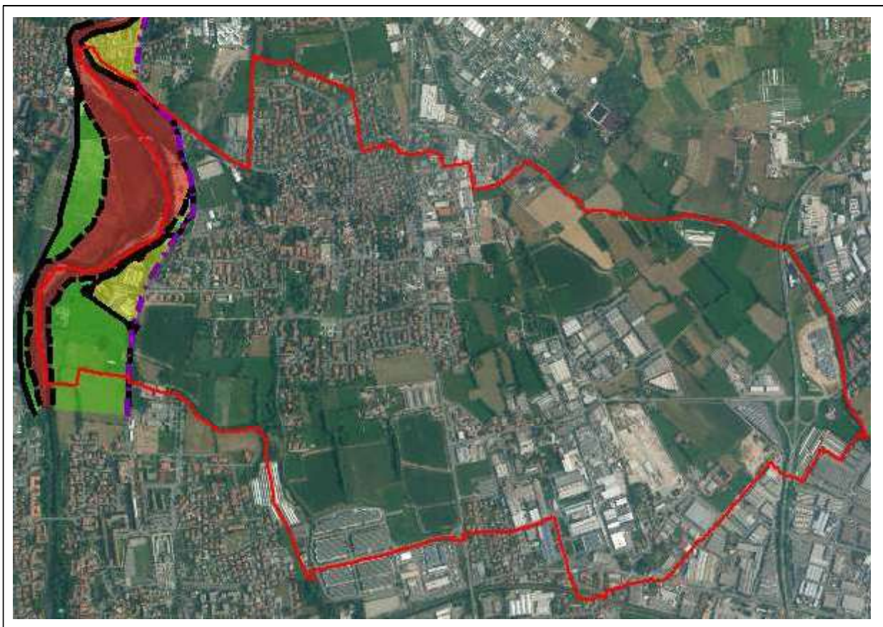
Figura 2: Porzioni del territorio di Pedrengo comprese nelle Fasce del P.A.I. (in rosso Fascia A, in verde Fascia B e in giallo Fascia C).
